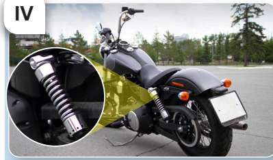
IV Motosikletin ağırlığı ile sıkışan çelik yay
